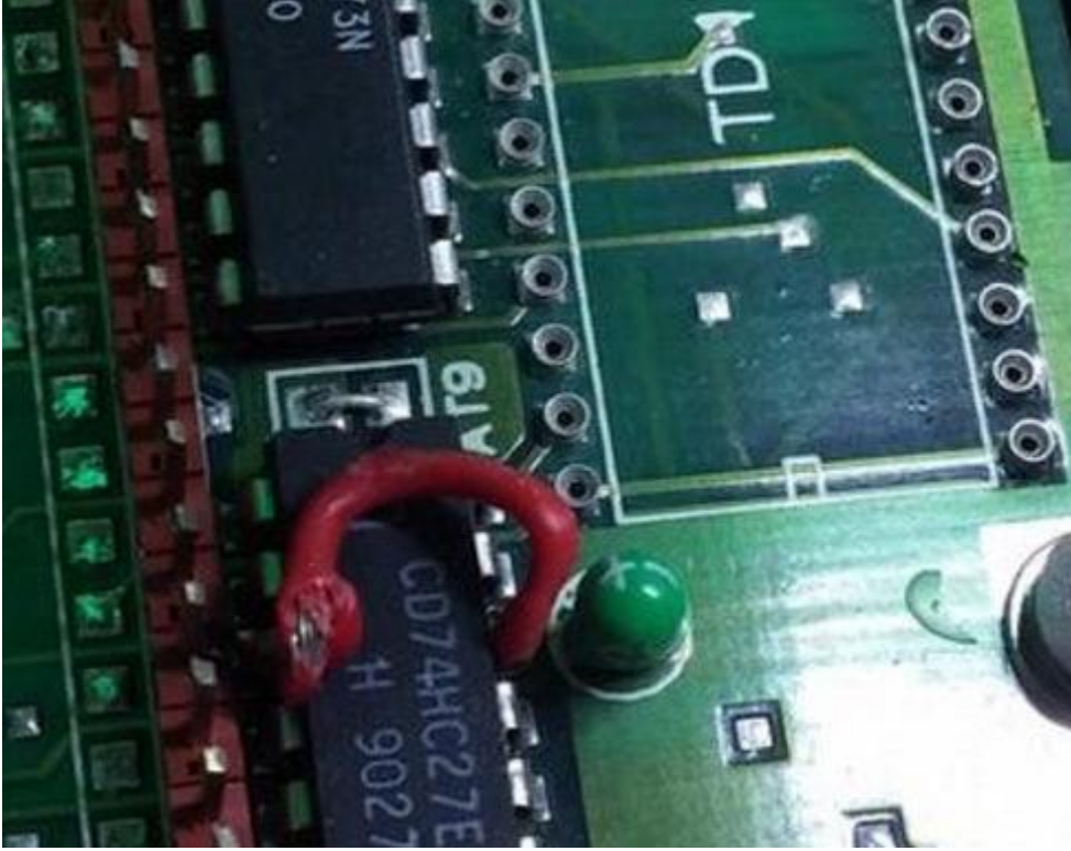
Resim-31. Entegre bacaklarının kısa bir kablo yardımı ile kısa devre edilmesi.
