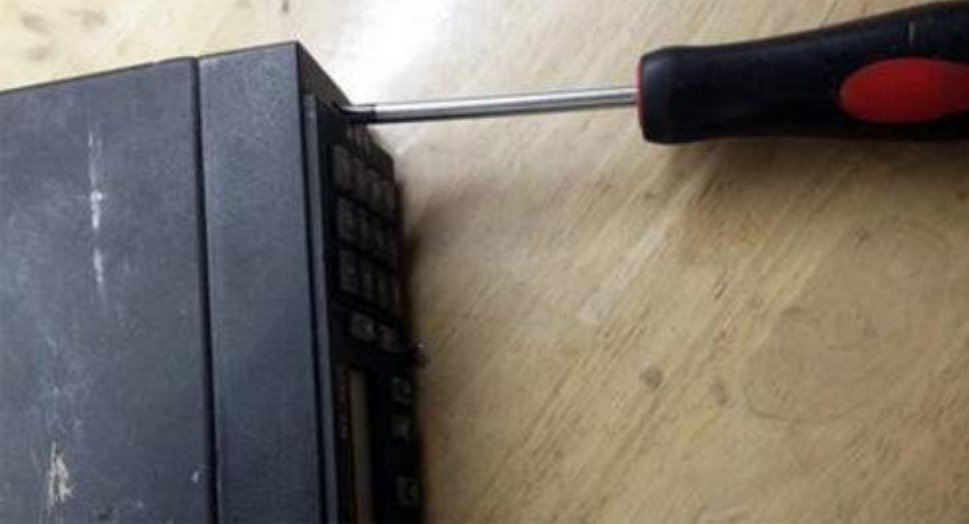
Resim-6. Ön panel vidalarının sökülmesi.
