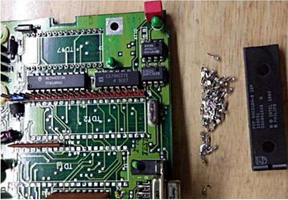
Resim-20. Entegre bacaklarının temizlenmesi.
