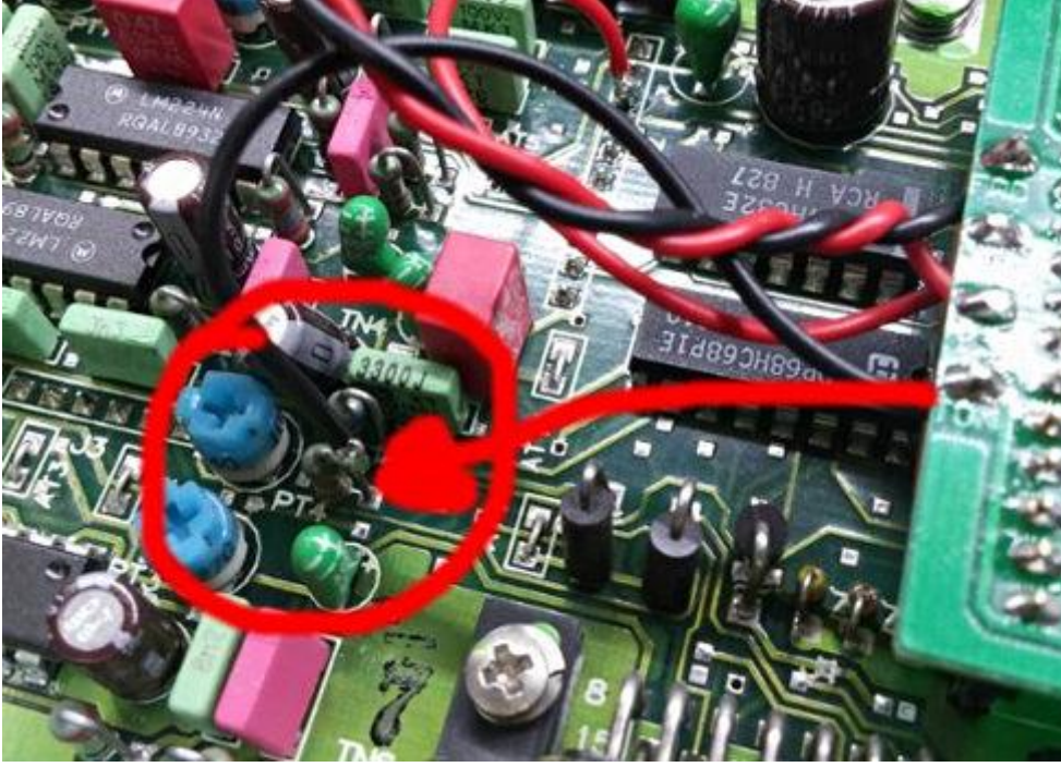
Resim-35. TON kablosunun lehimlenmesi.
